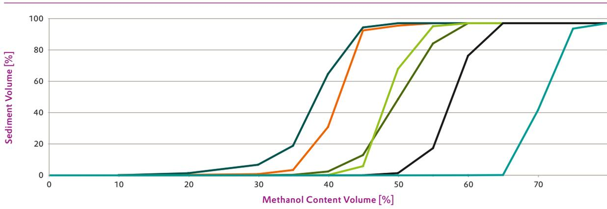
■ AEROSIL® R 972    ■ AEROSIL® R 805    ■ AEROSIL® R 812 S
